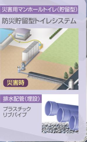
災害用マンホールトイレ(貯留型)「防災貯留型トイレシステム」
