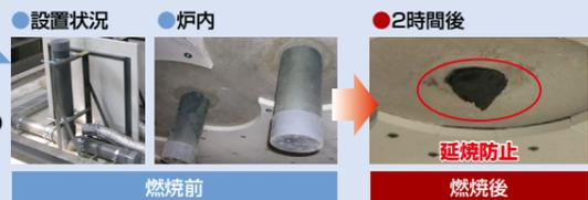
熱によりパイプの中間層が膨張し、貫通部からの熱気の浸入を遮断。火災の際の延焼を防止します。
